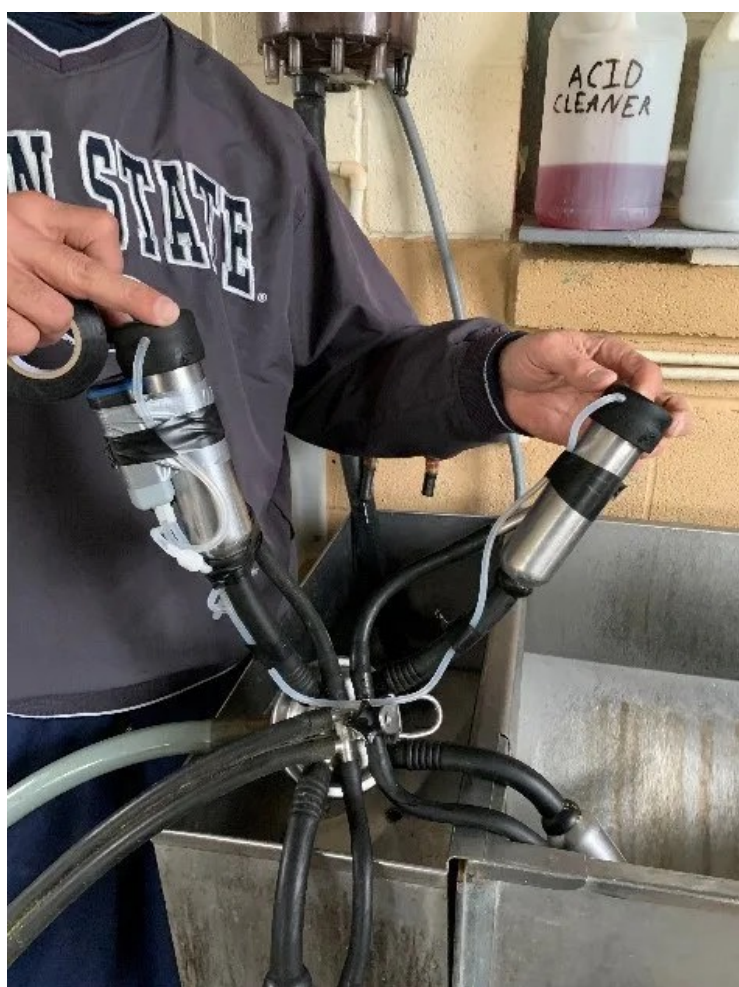
Imagen 1. Fotografía de un registrador de vacío VaDia asegurado a una garra de ordeño. Crédito de la foto: Carly Becker
